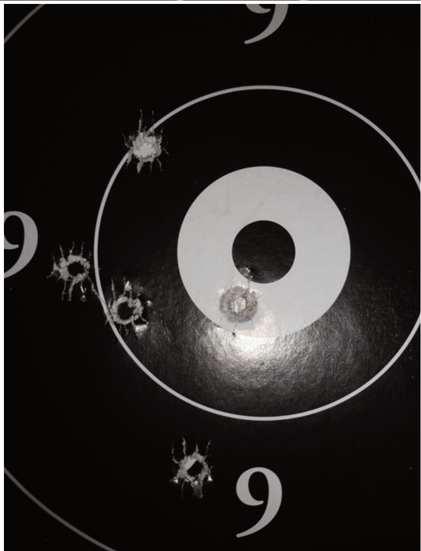
5 colpi a 200 metri, 2 colpi doppiati a ore 8 552 New Postel in piombo lubrificata con candela alla citronella 65 grani di svizzera 2F, borra in cartoncino.
