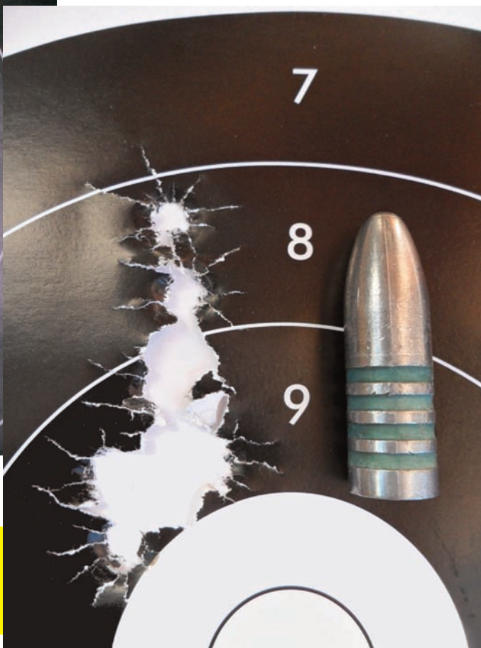
10 colpi a 100 metri, 552 New Postel in piombo lubrificata con 40% cera d'api, 40% paraffina e 20% vaselina 70 grani di svizzera 2F, nessun borraggio.
